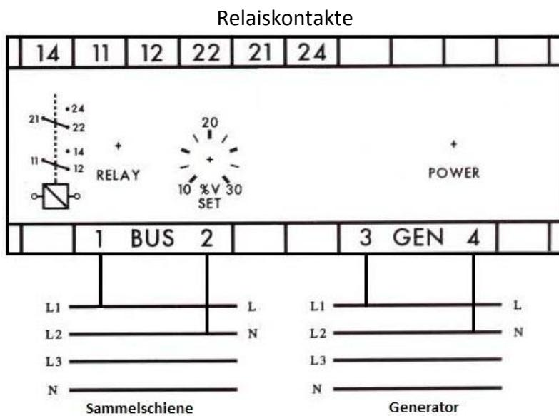
für 1 Generatorsystem mit Sammelschienenausfallschutz HO-R200-PS1-380
